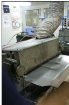
Detalle del proceso de recubrimiento por rodillos
