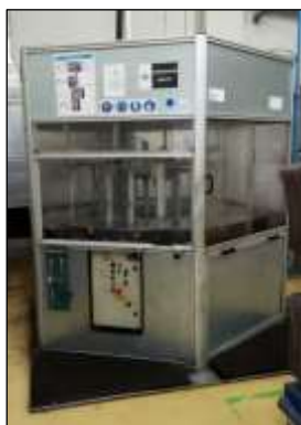
Cabina de impregnación
