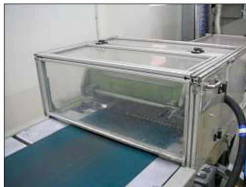
Detalle del proceso de recubrimiento por cortina
