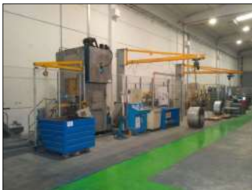
Línea de preparación del material armado (picado, montaje y calandrado).
