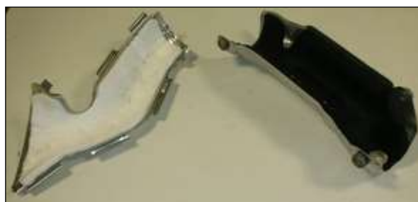
Ejemplos de pantallas térmicas de aislamiento directo (material BiTEC): (izq. vista superior, der. vista inferior)
