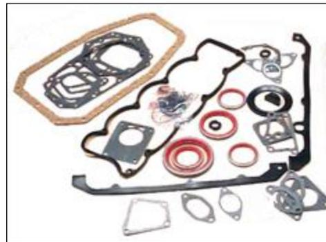
Ejemplos de junta de culata en material armado (derecha), MLS (centro) y juego de juntas (izquierda) envasados
