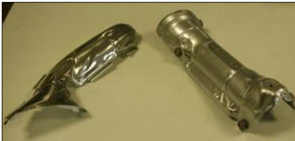
Ejemplos de pantallas térmicas de aislamiento directo (material BiTEC): (izq. vista superior, der. vista inferior)
